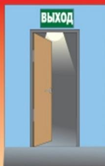
На эвакуационных выходах нельзя устанавливать раздвижные подъемно-опускные двери и вращающиеся двери и турникеты; Двери эвакуационных выходов и другие двери на путях эвакуации должны свободно открываться в сторону выхода. Они не должны иметь запоров, препятствующих свободному открыванию изнутри без ключа. На путях эвакуации необходимо иметь освещение.
