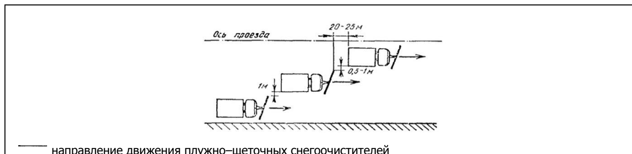
Рисунок 2.2 – Схема расчистки проезжей части улиц колонной плужно-щеточных снегоочистителей и складирование снега в лотке
