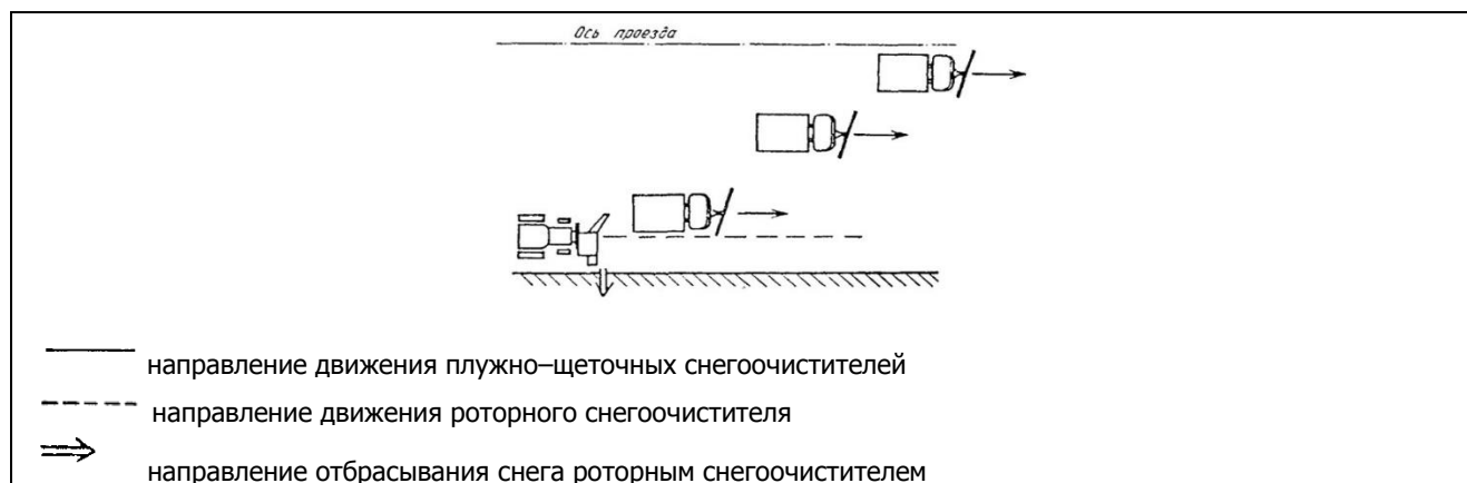
Рисунок 2.3 – Схема расчистки проезжей части улиц колонной плужно-щеточных снегоочистителей и перекидывание снега роторным снегоочистителем
